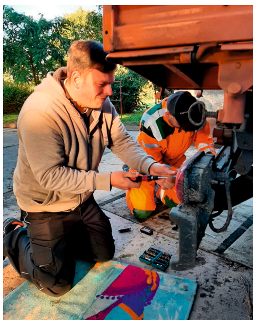
Stefan Bartsch beim Prüfen und Wechseln der Bremslichter an einem Stadtwerke-Multicar vor dem TÜV-Termin.
